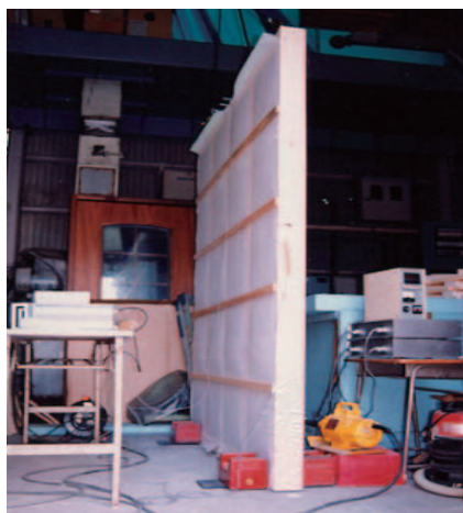
24時間の加振動試験の後目視による壁体内CFを確認
