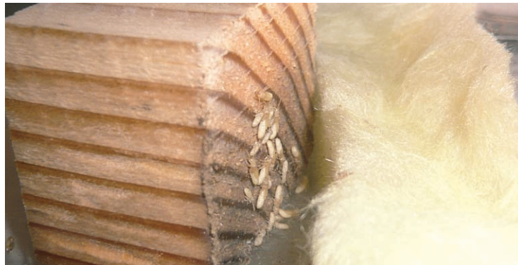
● グラスウール⇒直後に群がり食害発生
